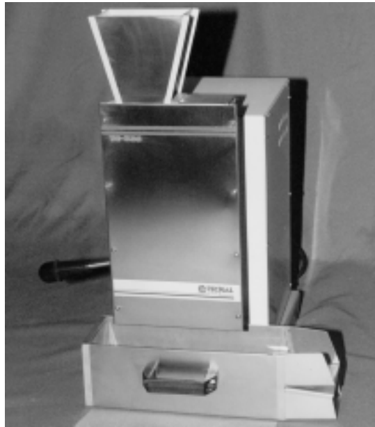
Figura 4.1. Moinho elétrico para moagem e definição da granulometria final da amostra de solo.
