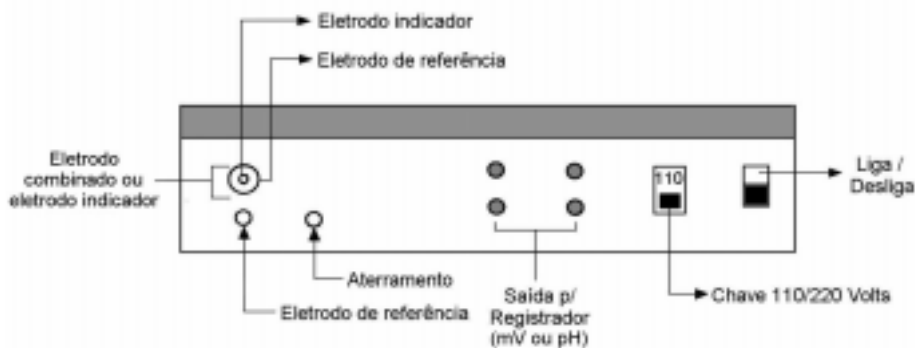
Figura 5.2. Esquema usual do painel traseiro de um potenciômetro. As conexões dos eletrodos e os demais controles podem variar de acordo com o fabricante. Consulte o manual do seu equipamento.
