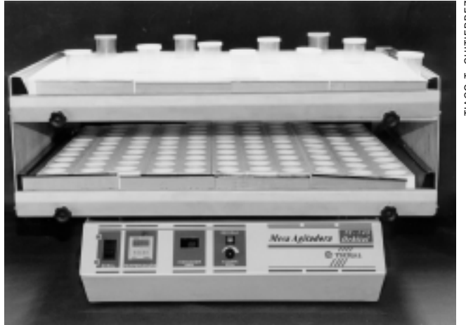
Figura 4.2. Mesa agitadora com movimento circular-horizantal, com rotação mínima de 220 rpm. A fotografia mostra equipamento de bancada com capacidade de 240 frascos cilíndricos de 100 mL. Existe também equipamento com sistema de sustentação próprio.
