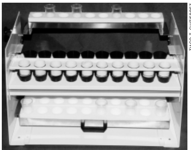
Figura 4.3. Aparelho separador de resina empregado para separar simultaneamente dez amostras de solo após a extração com a resina.
