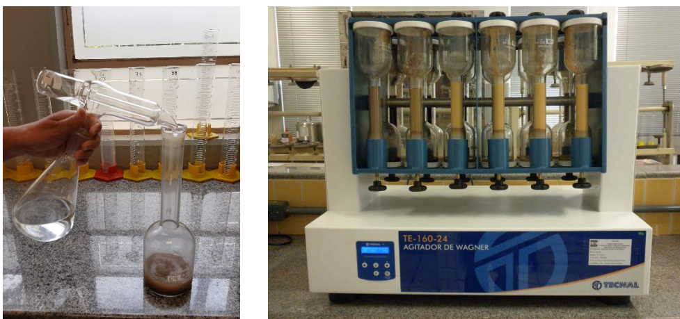
Figura 4. Dosagem do dispersante e agitador de amostras com garrafas de Stohmann
