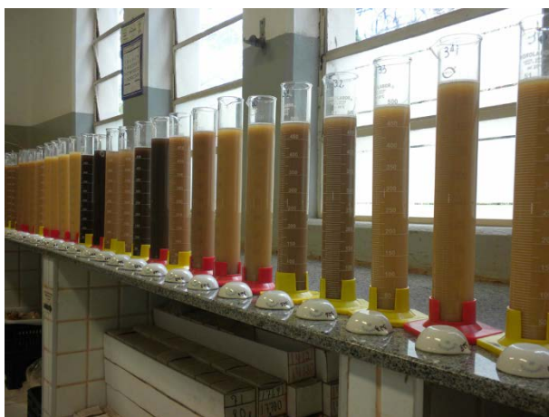
Figura 6. Suspensão com frações silte e argila aguardando o tempo de sedimentação.
