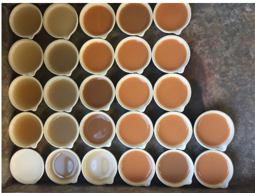
Figura 7. Alíquotas da fração argila e do dispersante para secagem em estufa.
