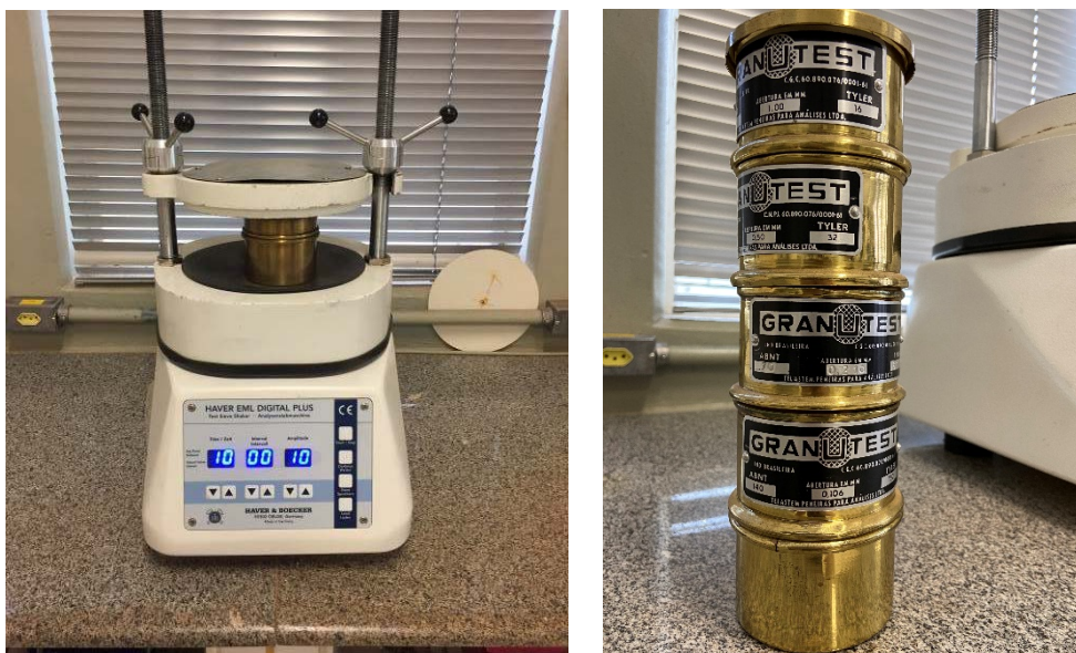
Figura 6. Agitador para separação das frações de areia e conjunto de peneiras para separação em 5 frações.
