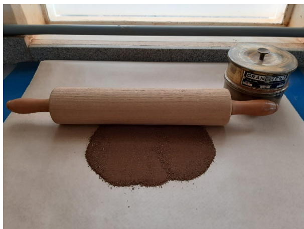
Figura 2. Preparo da amostra para análise granulométrica: apoio de borracha, rolo de madeira e peneira 2mm com tampa para agitar a amostra.
