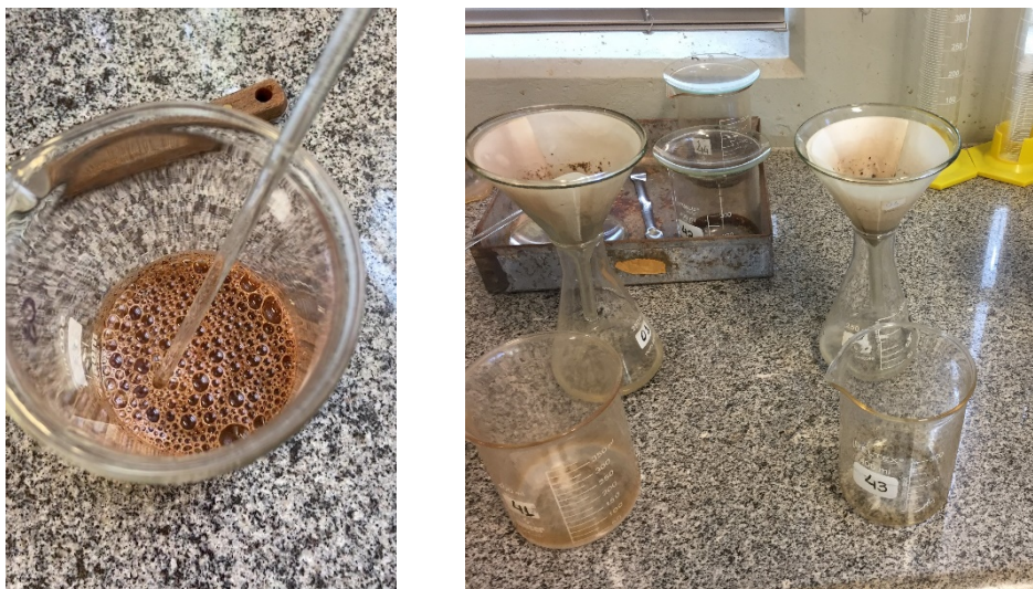
Figura 3. Adição de água oxigenada e lavagem da amostra de solo.
