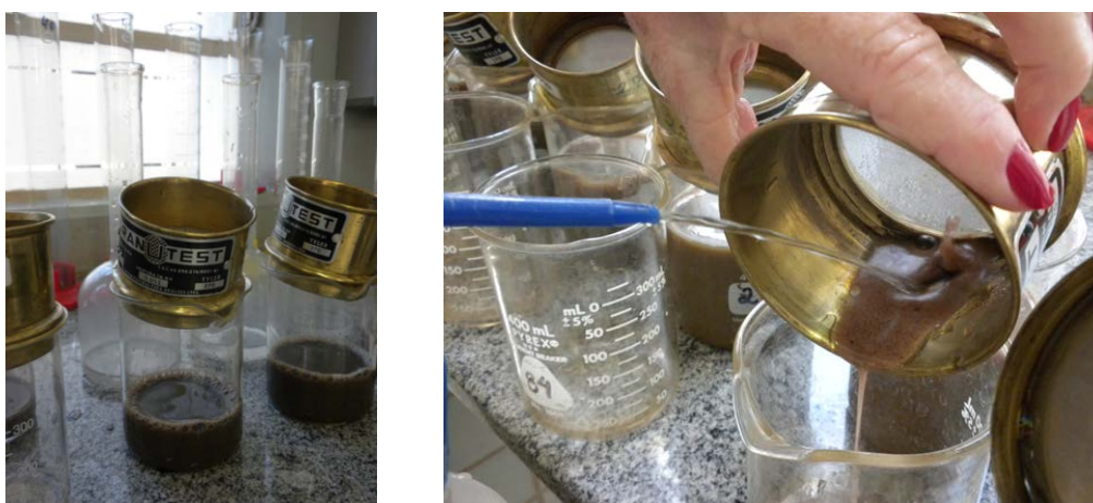
Figura 5. Separação da fração areia utilizando a peneira de abertura de malha 0,053 mm.
